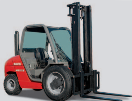
MSI 30 G con serbatoio fisso per GPL (la versione standard è con predisposizione per bombola per GPL)
